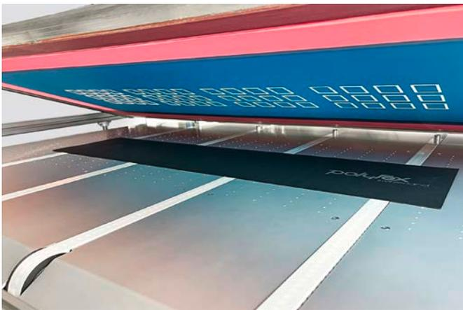
■ 在刮胶的过程中，下一张纸卡通过真空吸盘准备就绪。然后精确定位。
