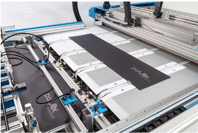
■ 自动卡片喂入系统带有光学光电管监控卡片堆叠高度。
